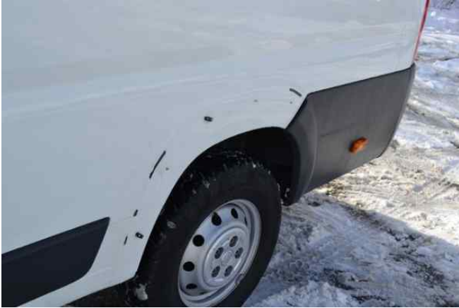
12. Seitenwand - Hinten - Links Beschädigt
