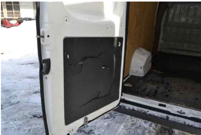
2. Kofferraum - Hinten - Links : Verkleidung Beschädigt
