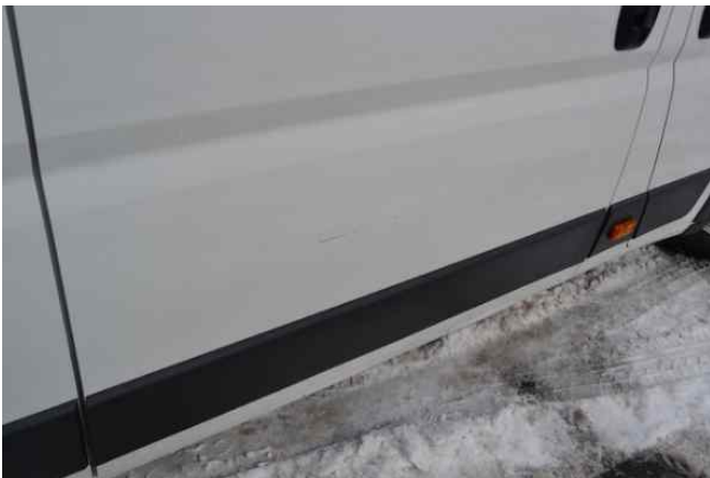
8. Schweller - Rechts Kratzer
